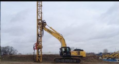
ELS Excavator Lead System • 45 Ft - 110,000 Lb Carrier • 60 Ft - 184,000 Lb Carrier
